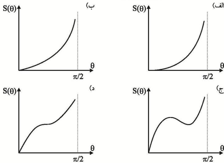
(۲۲) سطح آینه‌ای با افق زاویه‌ی  $\theta$  می‌سازد. در زمان  $t = 0$  گلوله‌ای با سرعت اولیه‌ی  $v_0$  و با زاویه‌ی  $\varphi$  نسبت به سطح آینه پرتاب می‌شود. مسیر حرکت در صفحه‌ی عمود بر نقاط آینه و سطح افق است. در چه زمانی فاصله‌ی گلوله از تصویرش در آینه، بیش‌ترین مقدار است؟
