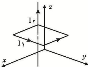
(۵) مطابق شکل از حلقه‌ای به شکل مربع که صفحه‌ی آن موازی صفحه‌ی  $xy$  است جریان  $I_1$  می‌گذرد. از سیمی بسیار بلند عمود بر صفحه‌ی مربع، که از مرکز آن می‌گذرد در جهت مثبت محور  $z$  جریان  $I_2$  عبور می‌کند. نیروی مغناطیسی کل وارد بر حلقه کدام است؟
