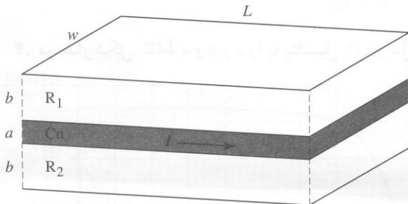
۲. نوار مسی نازکی به عرض  $w$ ، ضخامت  $a$ ، و طول  $L$  (در حدود متر) در اتاقی به دمای  $T = 300 \text{ K}$  قرار گرفته. از این نوار یک جریان الکتریکی به شدت  $I$  در جهت طول نوار می‌گذرد. نوار فقط می‌تواند با تابش با محیط اطرافش تبادل گرما بکند. وقتی جسمی به مساحت  $A$  و دمای مطلق  $T_2$  در اتاقی به دمای مطلق  $T_1$  قرار می‌گیرد، با توان  $A\sigma T_2^4$  انرژی از دست می‌دهد، و با توان  $A\sigma T_1^4$  از محیط انرژی می‌گیرد، که در اینجا  $\sigma$  ثابت است.
